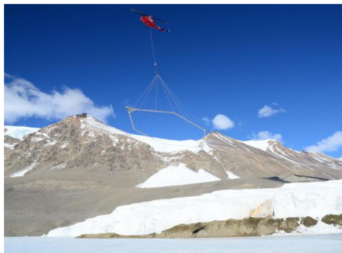
Вертолет с системой дистанционного электромагнитного зондирования над окраиной долины Тейлора / L. Jansan
