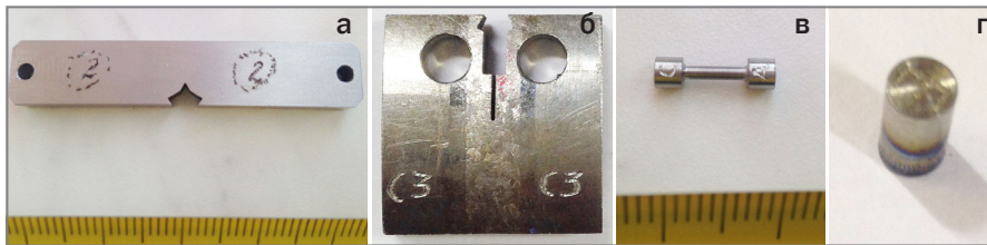
Рис. 1. Внешний вид: образцов-свидетелей для испытаний на вязкость разрушения (а, б) и на кратковременные механические характеристики (в); нейтронно-активационных индикаторов (г). Образец (а) выполнен из стали 08Х18Н10Т; образцы (б, в) – из сплава Э-125
