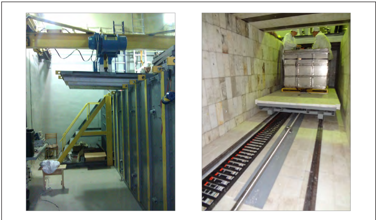
Рис. 1. Общий вид пассивной защиты нейтринного детектора на реакторе СМ-3 снаружи (слева) и изнутри (справа)
