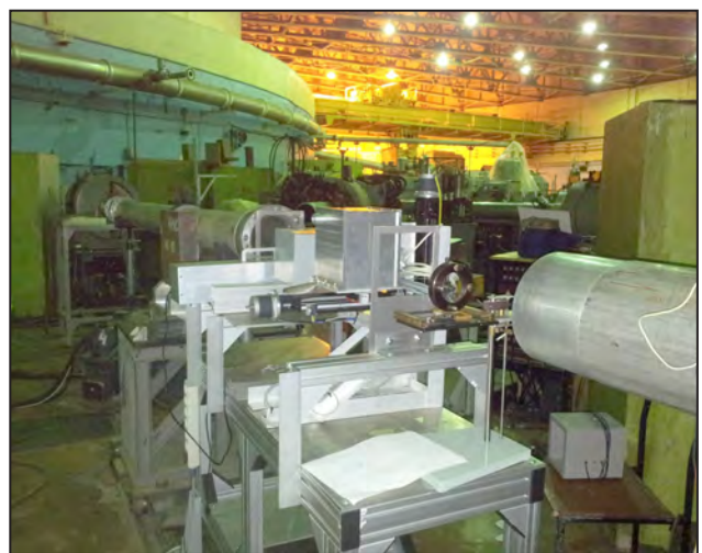
Установка для радиационных испытаний ЭКБ
