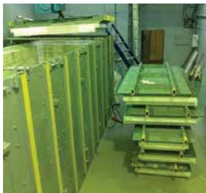
Рис. 2. Смонтированная пассивная защита на реакторе СМ-3 для эксперимента «Нейтрино-4»
