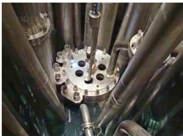
Проведение ультразвукового контроля корпуса ПИК.01.000. Слева: ввод штанги УЗ-системы в крышку корпуса; справа: касание датчиков внутренней поверхности корпуса
