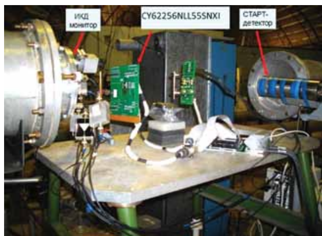
Испытания электронной компонентной базы на нейтронном пучке ГНЕЙС (ПИЯФ)
